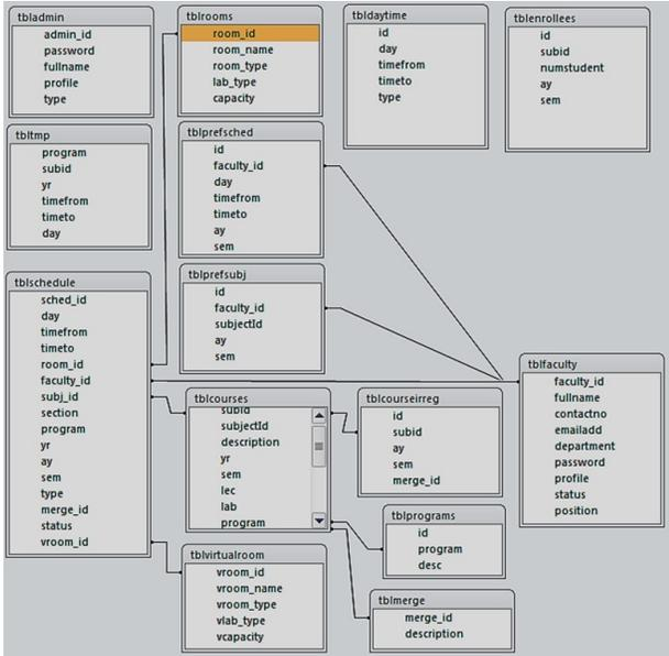
**Figure 3 Database Schema**
