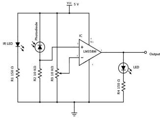
Fig. 6. IR Sensor Circuit
