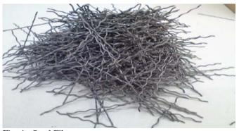
Fig. 4 - Steel Fibres
