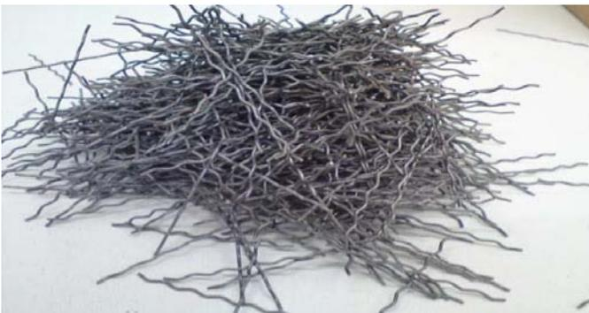
Fig. 4 - Steel Fibres
